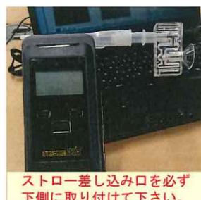
ストロー差し込み口を必ず下側に取り付けて下さい。
