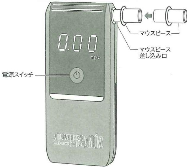
《梱包内容》・AC-016…電気化学式小型アルコール検知器(1台)
